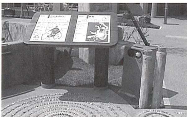
・点字・触知図付き案内板、音声誘導装置、誘導鈴（富士山こどもの国）
